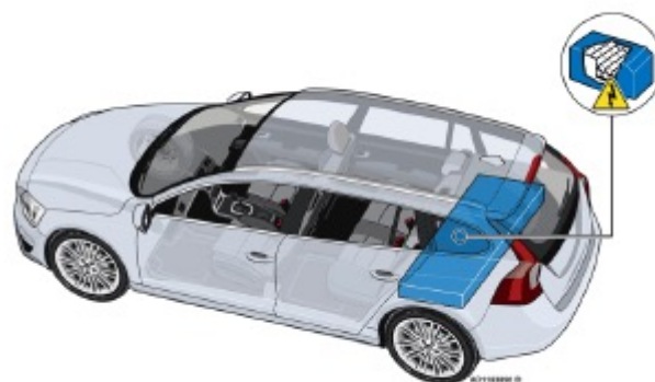
Figura 2. Localización del conjunto de baterías.
